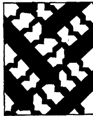
Рис. 7. Направленный рисунок протектора повышенной проходимости
