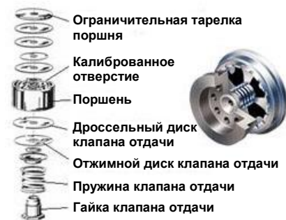
Клапан сжатия (клапан днища)
