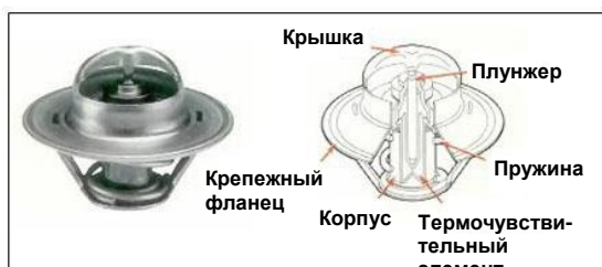
Термостат с обратным клапаном
