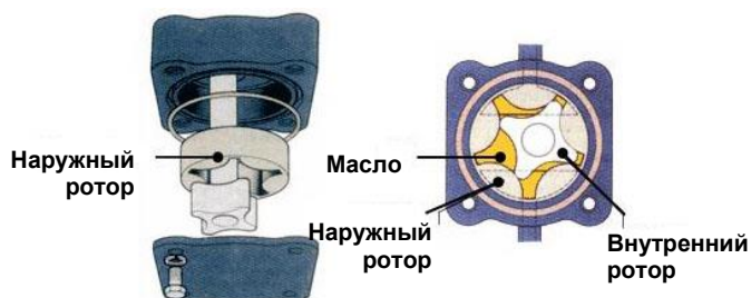
Роторный насос (трохоидального зацепления)
