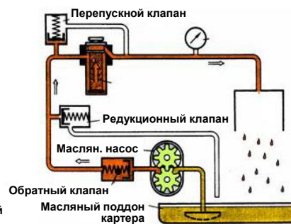
Система смазки с мокрым картером
