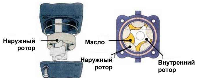
Роторный насос (трохоидального зацепления)
