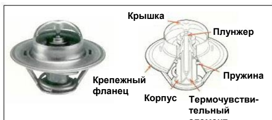
Термостат с обратным клапаном
