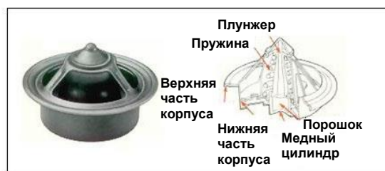
Термостат с пропорциональной муфтой
