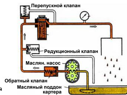
Система смазки с мокрым картером
