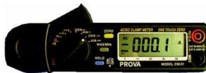
Проверка силы тока свечи накаливания
