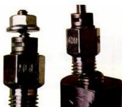
Неисправности, вызванные неправильным моментом затяжки свечей
