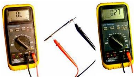
Проверка сопротивления свечи накаливания
