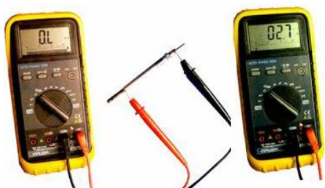
Проверка сопротивления свечи накаливания
