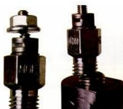
Неисправности, вызванные неправильным моментом затяжки свечей
