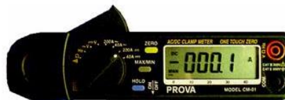
Проверка силы тока свечи накаливания
