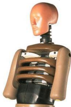
Грудь, манекен для испытания на боковой удар
