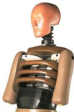
Грудь, манекен для испытания на боковой удар
