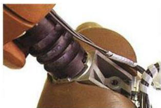
Шея, манекен для испытания на фронтальный удар
