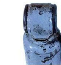
Трещины на нижней проушине
