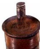
Последствия затяжки неправильным моментом
